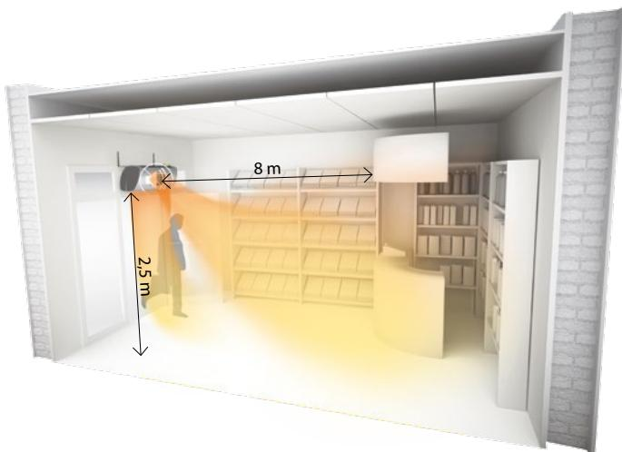
Domet zraka zračne zavese določa največjo višino za montažo. Za ELiS DUO je to 2,5 m – na tej višini ima ventilator v sekciji grelnika horizontalni domet 8 m.
